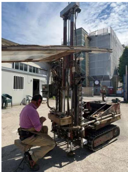
Fig. 7: postazione prova penetrometrica P1
