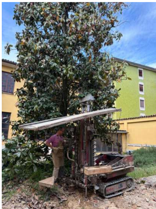
Fig. 9: postazione prova penetrometrica P2
