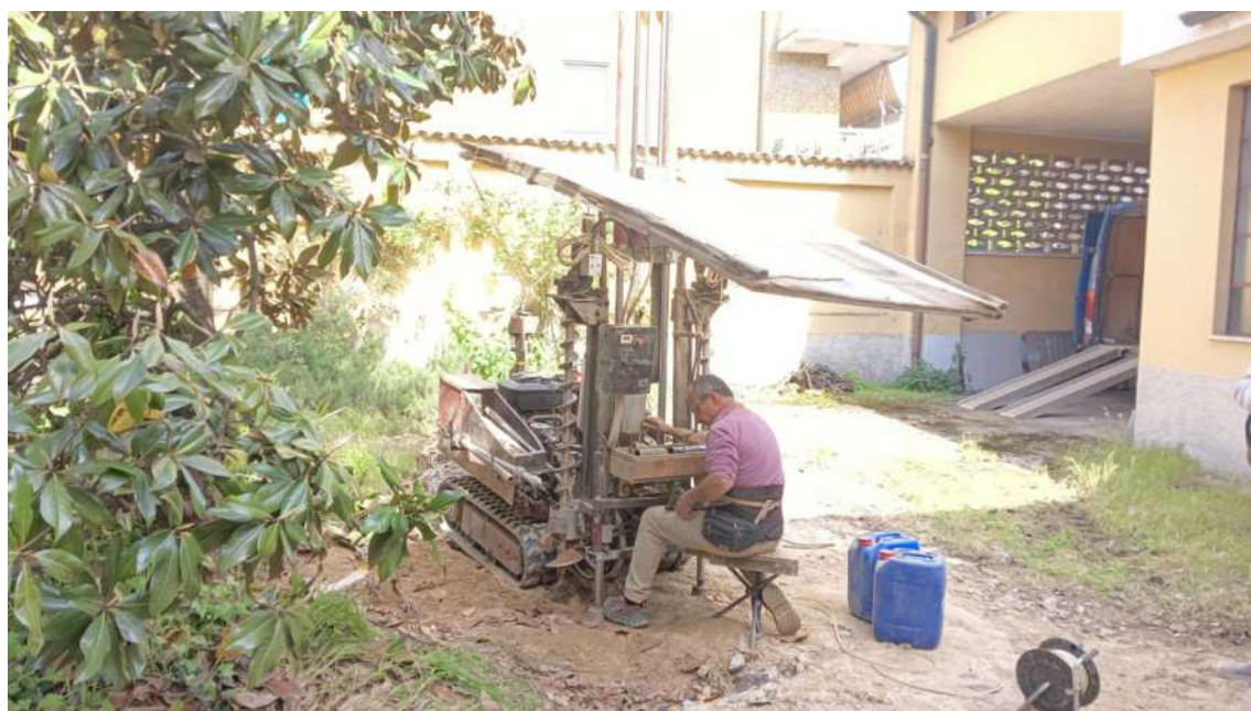
Fig. 10: esecuzione prova di permeabilità K_1
